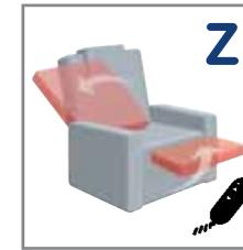
**Z** getrennte Verstellung von Fußstütze und Rücken mittels 2 Elektromotoren bis zur Herz-Waage-Liegeposition
